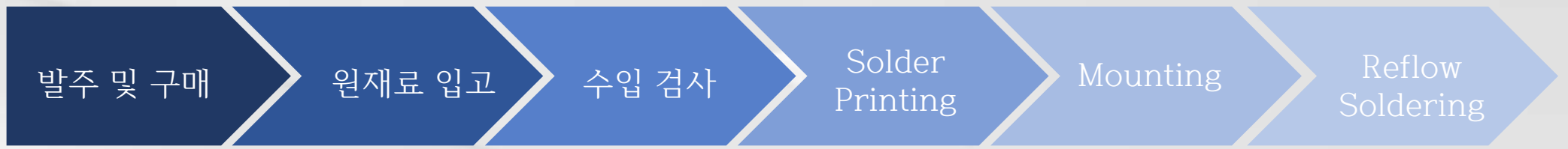
발주 및 구매 PCB PCB이상 유무 검사 PCB에 Solder Cream 도포 PCB에 부품 실장 실장된 부품을 PCB에 접합
